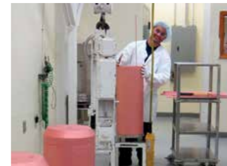
多芯坯料组装
