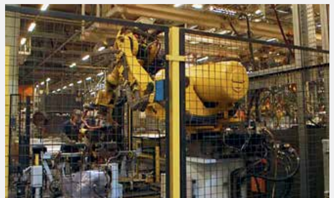
Завод Nissan в Сандерленде: процесс сварки при улучшенных параметрах с уменьшением выплеска
