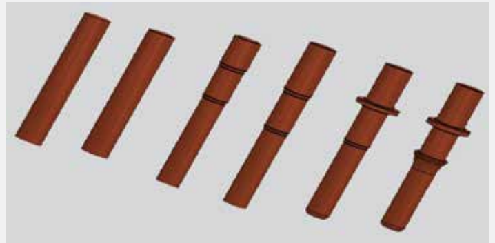
Kaltumformprozess des Steckverbinders
